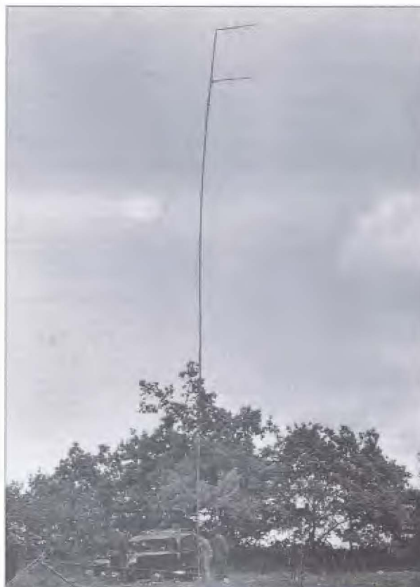
Fältstyrkemätning för RL-02 förbindelse, mast med två yagi-antennor.
